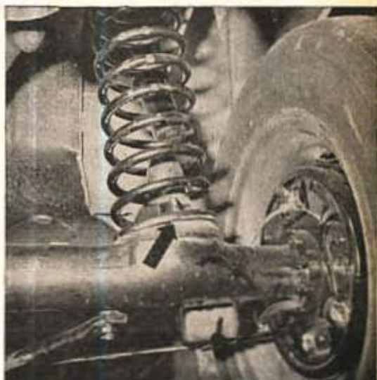
Fig. 94. — Orientation de la spire inférieure des ressorts arrière
