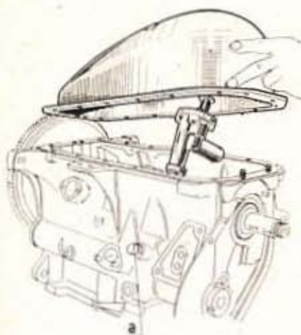
Fig. 32. — Dégagement de la pompe à huile
