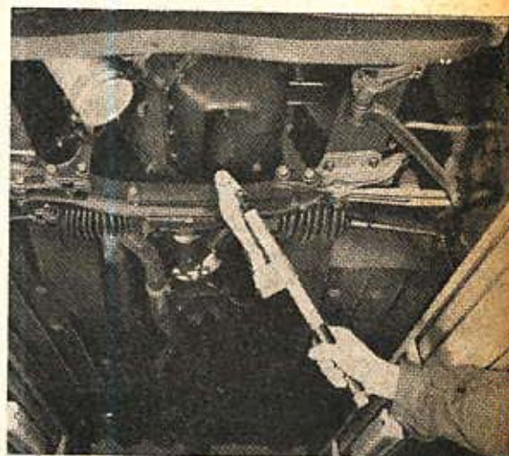
Fig. 126. — Blocage des vis de fixation du carter de direction sur traverse AV
