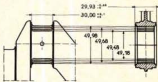
Fig. 39. — Cotes de rectification des manetons
