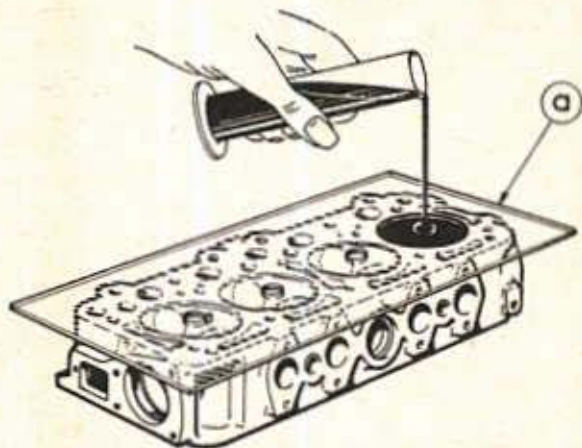
Fig. 4. — Contrôle du volume d'une chambre
