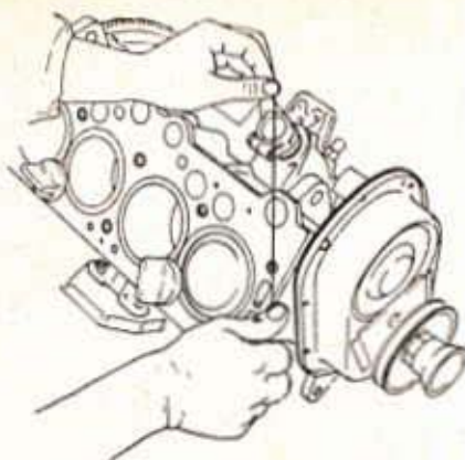
Fig. 50. — Contrôle de l'orientation du tournevis pour allumeur
