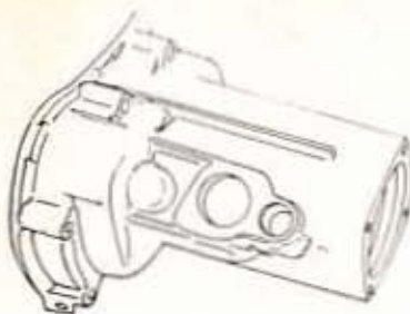
Fig. 70. — Remplacement du roulement AR dans carter AR
