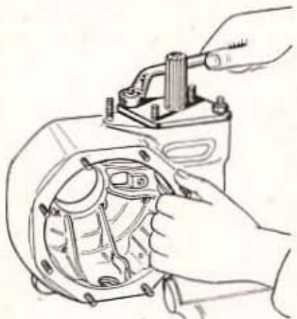
Fig. 106. — Serrer la plaque au moyen de 2 écrous opposés
