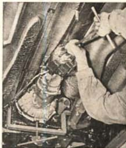
Fig. 93. — Dévisser les 4 vis d'assemblage du couvercle de rotule de poussée
