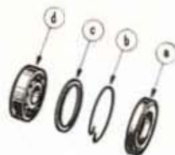
Fig. 70. — Remplacement du roulement AR dans carter AR
