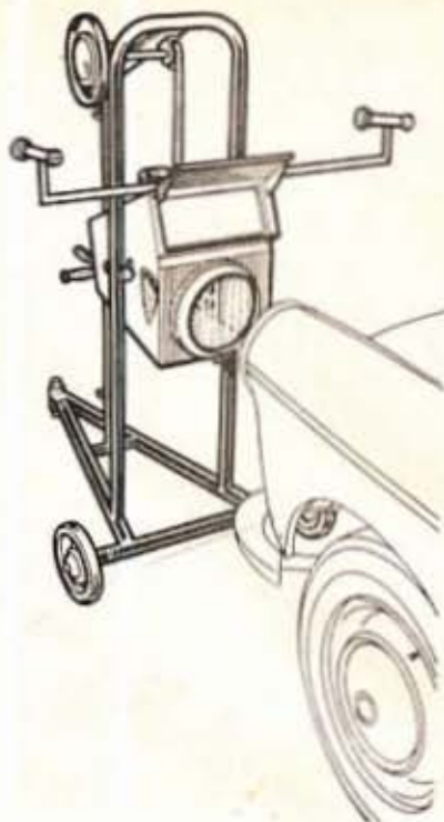
Vérification des projecteurs à l'aide du réglasscope Ciblé
