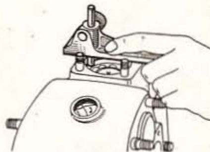
Fig. 107. — Mesure de la profondeur entre la face du carter et la bague extérieure du roulement
